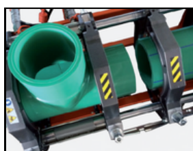
soldadura a tope
