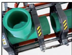
soldadura a tope
