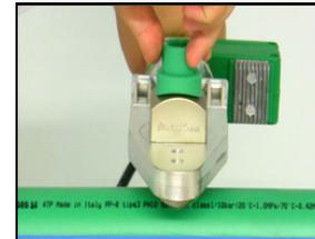
soudure des sièges
