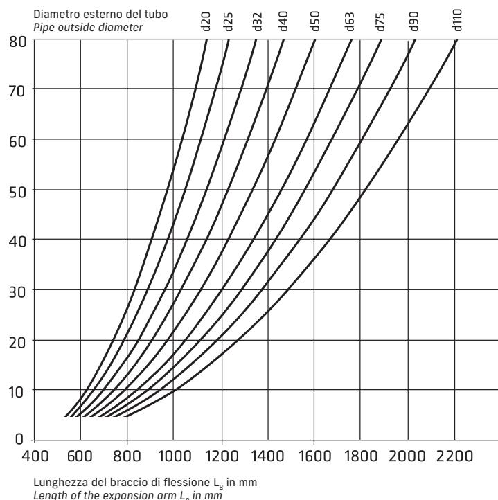
La lunghezza della curva ( $L_D$ ) deve essere non inferiore a 10 volte il diametro del tubo. La lunghezza del braccio ( $L_B$ ) può ricavarsi dal precedente diagramma.
