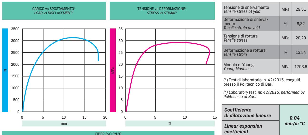
**TORO 25 FIBER EVO** associa alla caratteristica di ridotta dilatazione lineare dello strato interno FIBER, l'elevata performance meccanica degli strati PP-R EVO.
